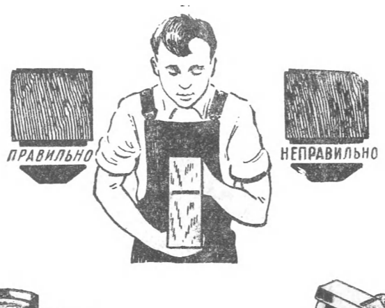
Рис. 18. Пиление: а — вдоль волокна; б — поперечное
