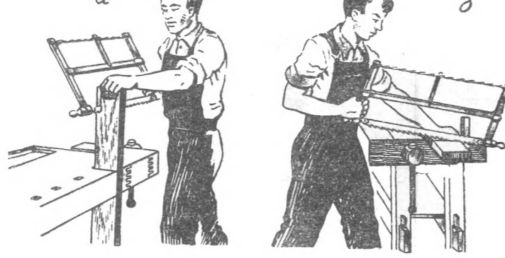
Рис. 18. Пиление: а — вдоль волокна; б — поперечное
