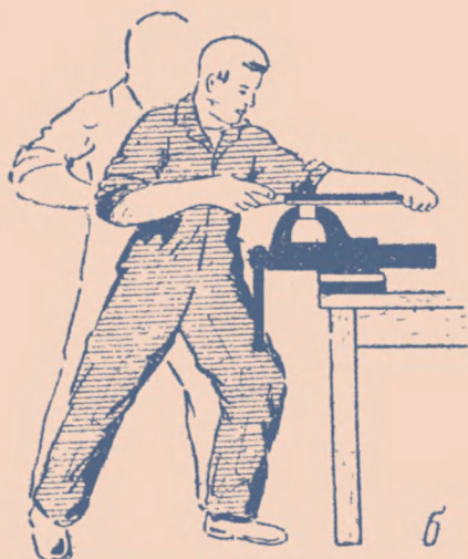
Рис. 21. б — работа напильником при снятии толстого слоя металла
