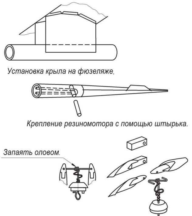
Рис. 5. Сборка моторной группы.
