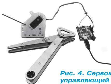
**Рис. 4. Сервомотор, управляющий большим рычагом.**
