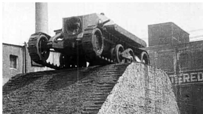
Кадры кинохроники. Экспериментальный танк M1921 проходит испытания на Абердинском полигоне. Лето 1922 г.
