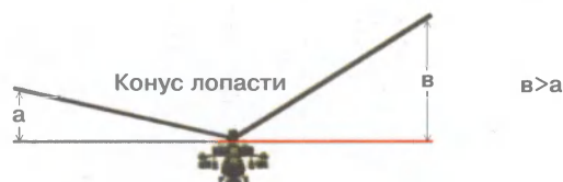
Рис. 3. Схема взаимодействия воздушного потока с лопастью несущего винта при горизонтальном полете вертолета.
