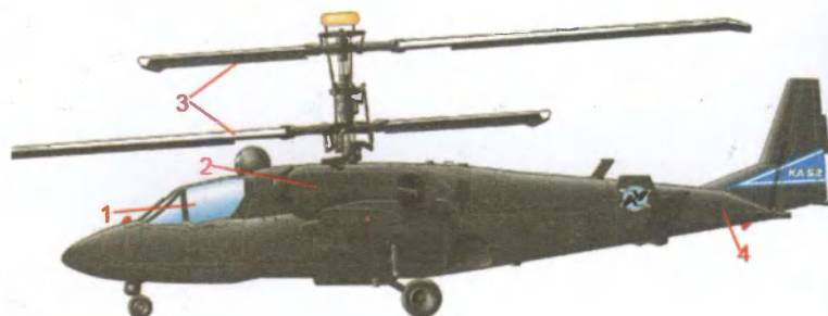
Рис. 2. Соосная схема вертолета.
