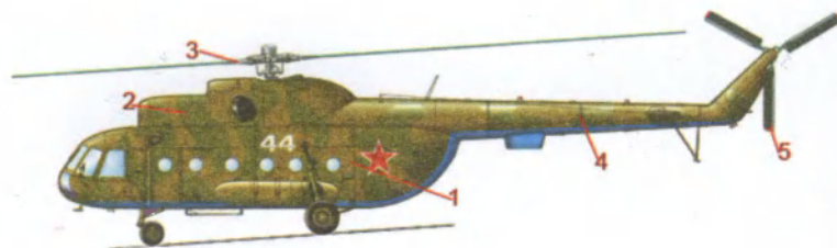
Рис. 1. Одновинтовая схема вертолета.
