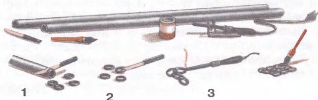
Рис. 3. Этапы изготовления колец и плетение кольчуги из трубки ПВХ: 1, 2 — нарезка и разрезка колец; 3 — плетение кольчуги и сварка колец.
