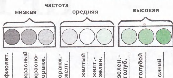
Рис. 7. Схема расположения лампочек по цвету и частотным каналам.
