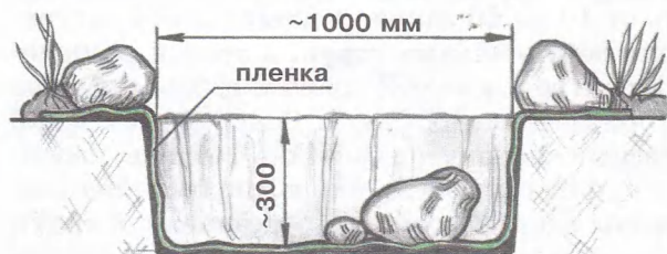
Рис. 5. Устройство бассейна фонтана.
