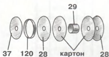
Устройство «ленивца» (носовая часть) ходовой части Т-28 (правый борт)
