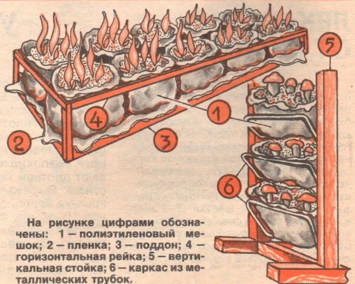
На рисунке цифрами обозначены: 1 — полиэтиленовый мешок; 2 — пленка; 3 — поддон; 4 — горизонтальная рейка; 5 — вертикальная стойка; 6 — каркас из металлических трубок.
