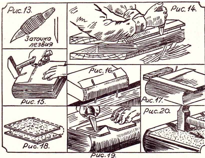
Теперь обрежьте книгу. Для этой работы нужен острый переплётный или сапожный нож, обмотанный бечёвкой или тесьмой (рис. 13). Положите книгу между двумя досками и обрежьте её передок (то есть правую сторону). Следите, чтобы обрез был строго параллелен корешку. Обрезайте как можно ближе к краю, чтобы не обрезать буквы (рис. 14).
