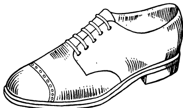
Рис. 21. Обувь с берцами, настроенными на союзку
