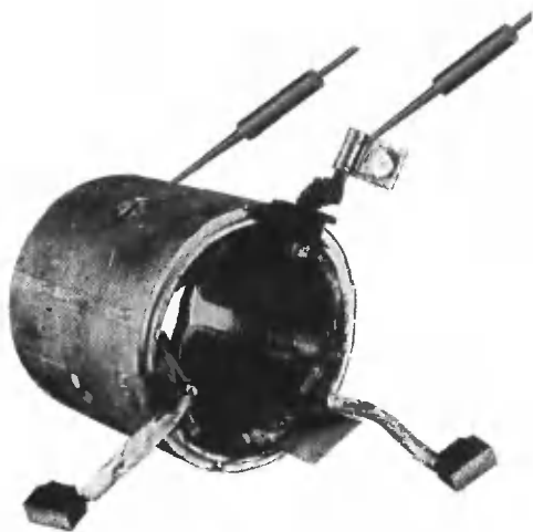
Рис. 34. Проверка катушек возбуждения стартера на короткое замыкание с корпусом
