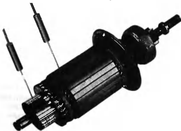
Рис. 36. Проверка обмотки якоря на отсутствие замыкания с магнитопроводом
