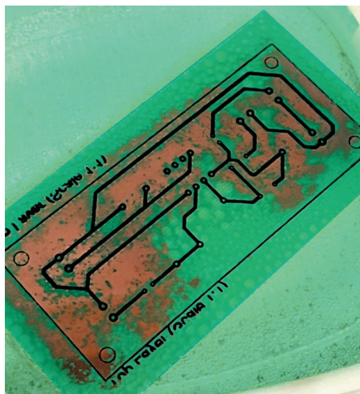
Рис. 5. Плата в процессе изготовления методом лазерно-утюжной технологии
