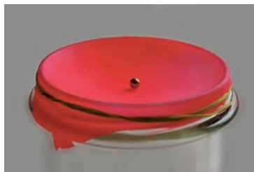
Рис.2. Из-за разности давлений воздуха резиновая пленка принимает сферическую форму
