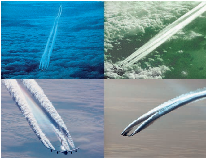
Рис.3. Вихревые следы за самолетом
