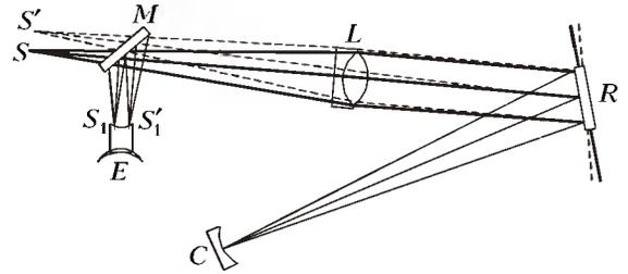
Измерение скорости света методом вращающегося зеркала (метод Фуко)
