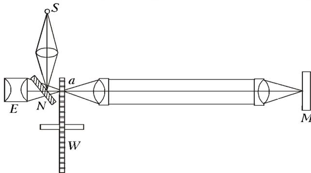
Определение скорости света методом Физо
