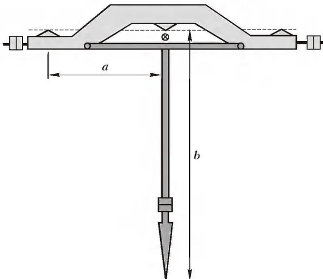
силы тяжести  $Mg$ , действующей на коромысло, равно  $\alpha a = \alpha l/b$ . Момент силы тяжести коромысла относительно оси вращения коромысла равен  $Mg\alpha l/b$ . Этот момент уравновешивается моментом силы тяжести перегрузка относительно той же оси вращения, равным  $mga$ :
