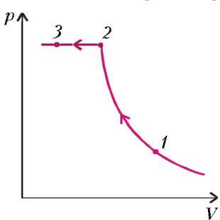
Уменьшая объем, занимаемый паром, мы обнаружим, что при определенной (для данной температуры  $T_0$ ) концентрации  $n_{\text{п}}$ , соответствующей состоянию 2 на диаграмме  $p$ – $V$  (см. рисунок), дальнейшего роста концентрации и, следовательно, роста парциального давления пара не происходит – пар становится насыщенным.
