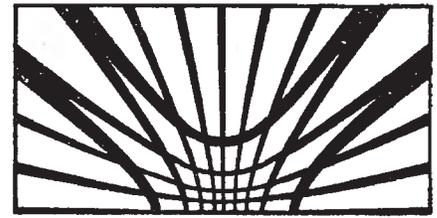
Рис.2. Диаграмма Аббе для проверки условия синусов
