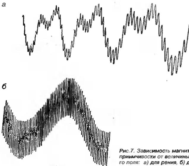
Рис. 7. Зависимость магнитной восприимчивости от величины магнитного поля: а) для висмута, б) для серебра
