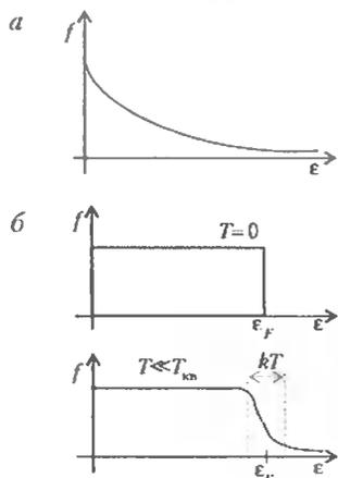
Рис. 1. Классическая и квантовая функции распределения электронов по энергиям. а) функция распределения Максвелла-Больцмана, б) функция распределения Ферми-Дирака (при  $T = 0$  и  $T \ll T_{kn}$ )
