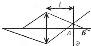
пятна минимальных размеров. Положение точек А и В находим по формуле линзы, а размеры пятна на экране — из подобия треугольников. Расстояние от линзы до точки А равно  $20/3$  см, до точки В — 10 см. Тогда  $(10 - l)/10 = (l - 20/3)/(20/3)$ . Отсюда  $l = 8$  см, а диаметр пятна  $d$  составляет 0,2 от диаметра линзы, т.е.  $d = 2$  мм.
