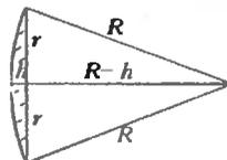
ти  $R$ . Геометрически такая линза представляет собой шаровой сегмент, изображенный на рисунке. Безразмерное отношение  $h/R$  обозначим  $\lambda$  и учтем, что  $\lambda \ll 1$ . Согласно теореме Пифагора, запишем  $R^2 = (R-h)^2 + r^2$ , откуда имеем  $r^2 = 2Rh - h^2 \approx 2R^2\lambda$ . Теперь найдем диаметр линзы:  $d = 2r$  и отношение  $h/d$ :
