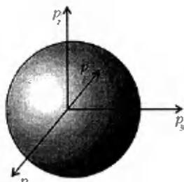
Рис. 2. При  $T = 0$  заполнена электронами сфера радиусом  $p_F = \sqrt{2m\epsilon_F}$
