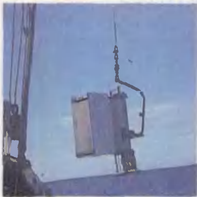
«Поток» — прибор для измерения скорости и направления течений
