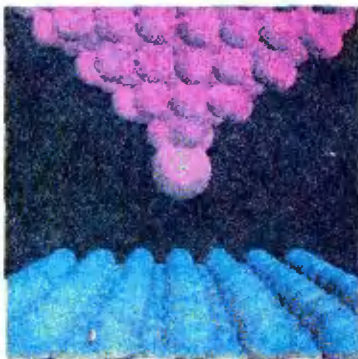
Перенос атома ксенона на поверхность кремния.
