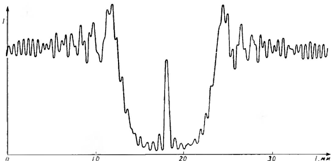
Рис. 7. Распределение освещенности при дифракции шарика.
