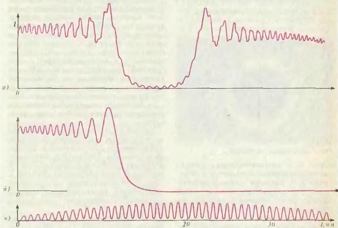
Рис. 3. Распределение освещенностей при дифракции от стержня (верхняя кривая), от края стержня (средняя кривая) и от двух щелей на краях стержня (нижняя кривая).
