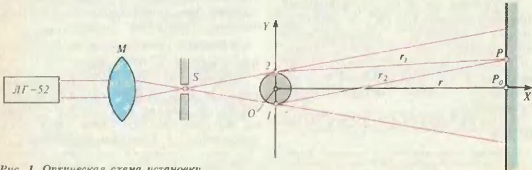
Рис. 1. Оптическая схема установки.
