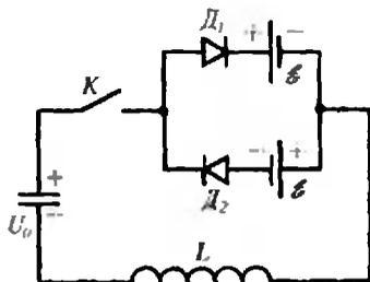
Как видно из рисунка, через диод  $D_1$  ток может течь только слева направо, а через диод  $D_2$  — только справа налево. Таким образом, данная цепь представляет собой колебательный контур, содержащий источник тока с постоянной ЭДС, включенной каждый раз навстречу току.
