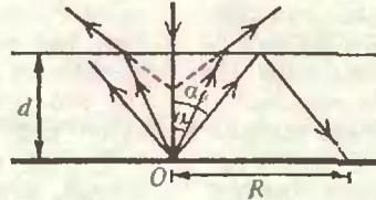
щие из точки  $O$  под углом, большим  $\alpha_0$ , снова попадают на закрашенную поверхность и освещают ее, создавая светящийся ореол. При этом радиус  $R$  неосвещенной области равен  $2d \operatorname{tg} \alpha_0$ , где  $d$  — толщина пластинки.
