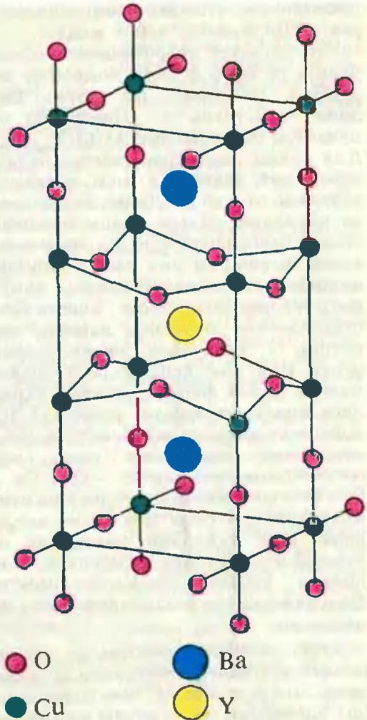
Структура кристаллической решетки соединения Y—Ba—Cu—O.
