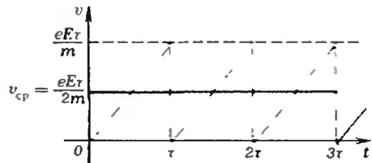
Такое кусочно-равноускоренное движение можно представить себе как равномерный дрейф электрона в направлении, противоположном полю, со скоростью  $v_{cp}=eE\tau/(2m)$ . Вычислим связанную с этим движением силу тока.
