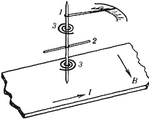
лку в противоположном направлении и растет с увеличением угла поворота. Такой противодействующий момент может быть создан, например, подходящей пружиной.
