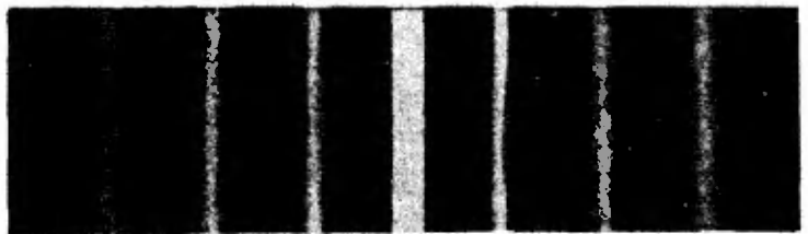
Дифракционная картина, полученная в монохроматическом свете с помощью дифракционной решетки.
