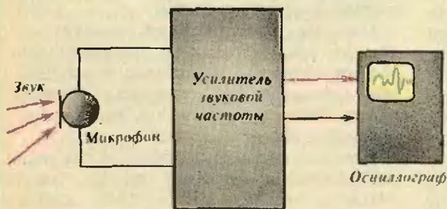
Рис. 5. Преобразование звукового сигнала в электрический.
