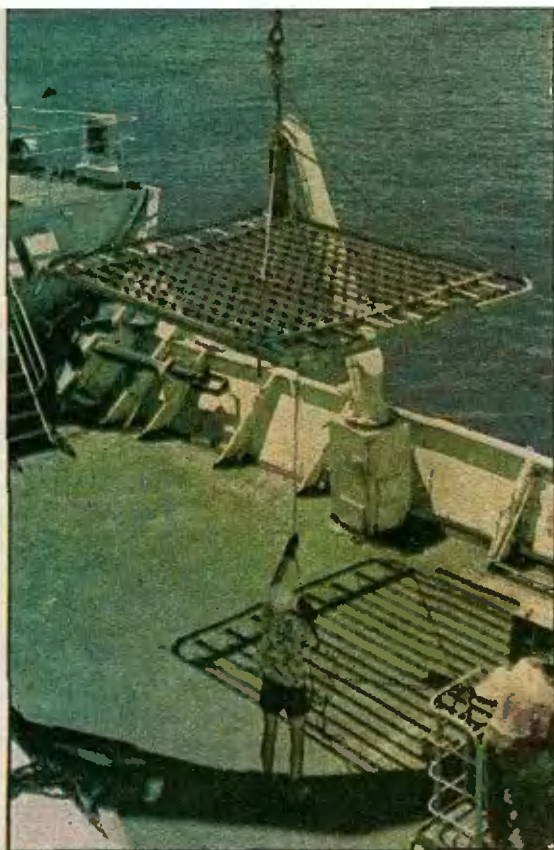
Спуск антенной решетки в эксперименте по акустической визуализации дна океана.
