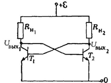
Рис. 3. Триггер на двух БТ. Схемы а) и б) полностью эквивалентны.
