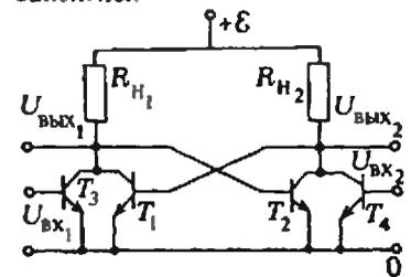
Рис. 4. Ячейка памяти на триггере с двумя входами.
