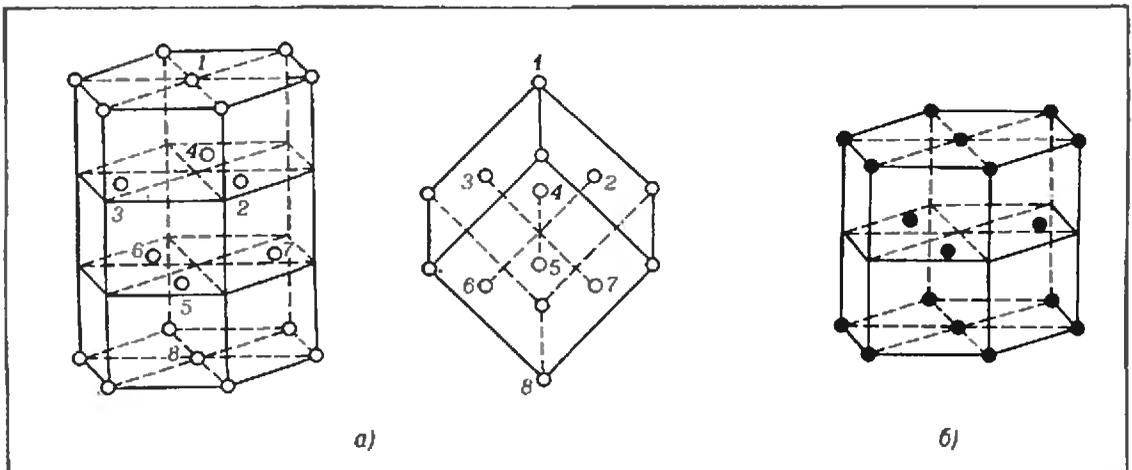
Рис. 6. Элементы гранцентрированной кубической решетки и гексагональной решетки с плотной упаковкой.
