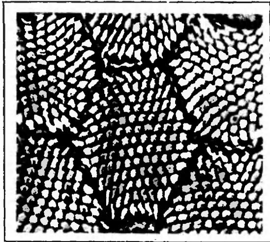
Здесь представлена фотография сечения сверхпроводящего кабеля — одного из последних достижений современной технологии. Он состоит из множества сверхпроводящих жил, расположенных в медной оболочке. Первоначально жилы имели цилиндрическую форму, но после обжатия превратились в шестиугольные призмы. Чем плотнее, регулярнее упакованы жилы, тем более правильные шестиугольники видны в сечении. Это — свидетельство высокого качества изготовления кабеля.
