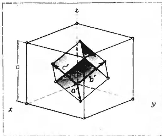
Рис. 7. Гранецентрированную кубическую решетку можно получить, периодически сдвигая в трех направлениях всего один атом.
