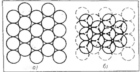
Рис. 2. Плотная упаковка шаров в пространстве (пунктиром показан нижний слой).
