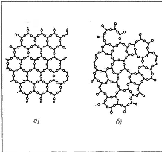
Рис. 10. Строение кварца (а) и стекла (б).
