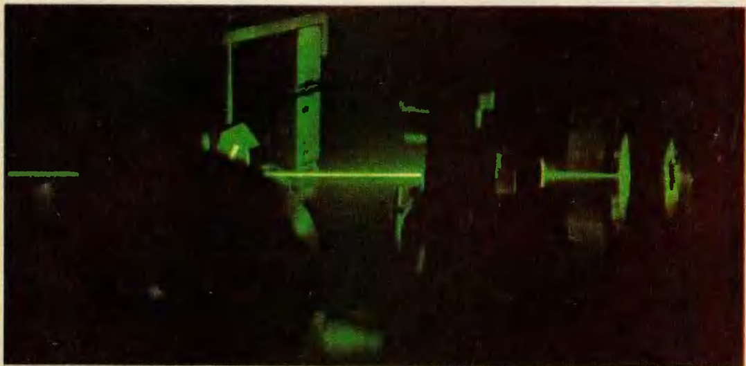
На фотографии показано, как инфракрасный луч лазера ( \lambda = 1064 нм) преобразуется в видимый свет ( \lambda = 532 нм) при прохождении через нелинейную оптическую среду. Ход невидимого инфракрасного луча от лазера до нелинейного преобразователя можно проследить по выходящему обратно из преобразователя слабому «отраженному» лучу.
