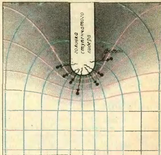
Рис. 1. Для возникновения электронных лавин наиболее существенны два фактора: усиление электрического поля перед головкой лидера (синим цветом показаны линии напряженности поля, красным — эквипотенциальные линии) и фотоионизация (нейтральные атомы ионизируются излучением, испускаемым головкой лидера).
