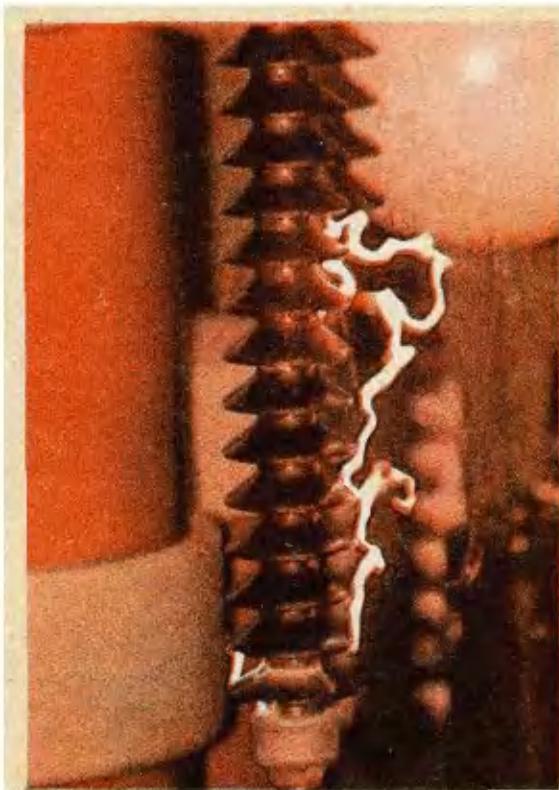
Рис. 4. Поверхностный пробой.
