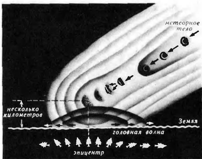
Схема влета в атмосферу и взрыва Тунгусского тела. Образовавшаяся у поверхности Земли головная волна и явилась причиной повала деревьев.
