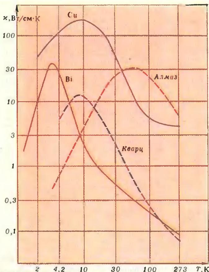
Рис. 1. Зависимость удельной теплопроводности от температуры для различных веществ. (Удельная теплопроводность — это количество тепла, которое протекает между противоположными гранями кубика со стороной 1 см при разности температур между этими гранями в 1 К.)
