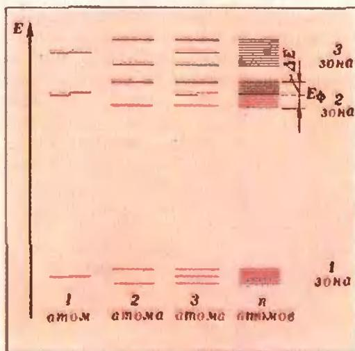
Рис. 3. Схема уровней энергии атома лития и их трансформации в зоны при объединении атомов в кристалл. Красным цветом нарисованы занятые состояния.
