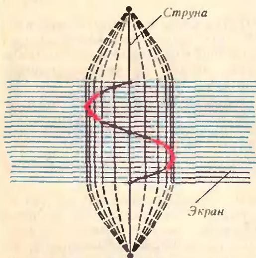
Рис. 4. На рисунке изображена только 21 строка, на самом деле в полукадре 312,5 (а в целом кадре — 625) строк.
