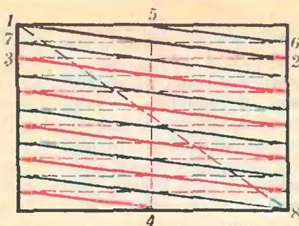
Рис. 1. Ход луча при чересстрочной развертке: 1—2 — начало нечетного полукадра; 5—6 — начало четного полукадра; 2—3, 4—5, 6—7 и 8—1 — обратный ход луча.
