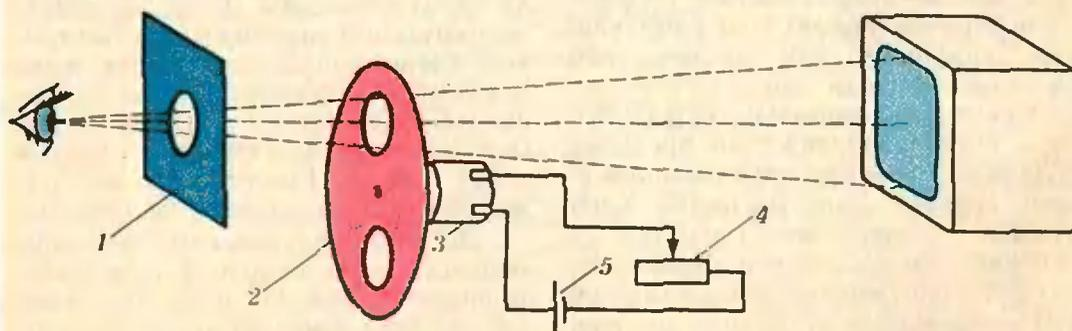
Рис. 2. Схема опыта с «классическим» стробоскопом: 1 — непрозрачный экран; 2 — вращающийся диск с отверстиями; 3 — микроэлектродвигатель; 4 — реостат; 5 — плоская батарейка.
