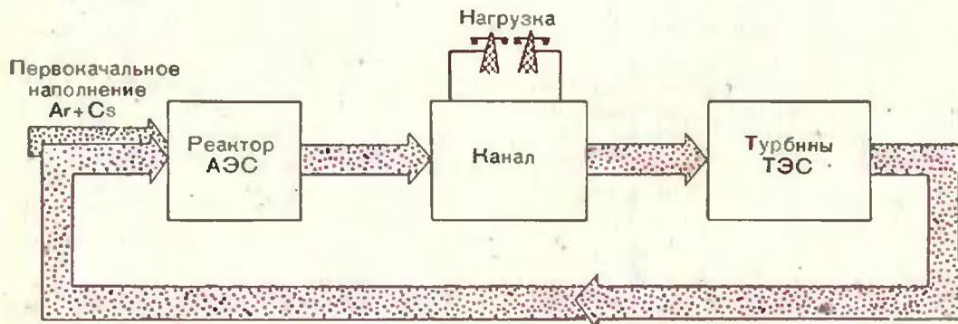
МГД-генератор с закрытым циклом.
