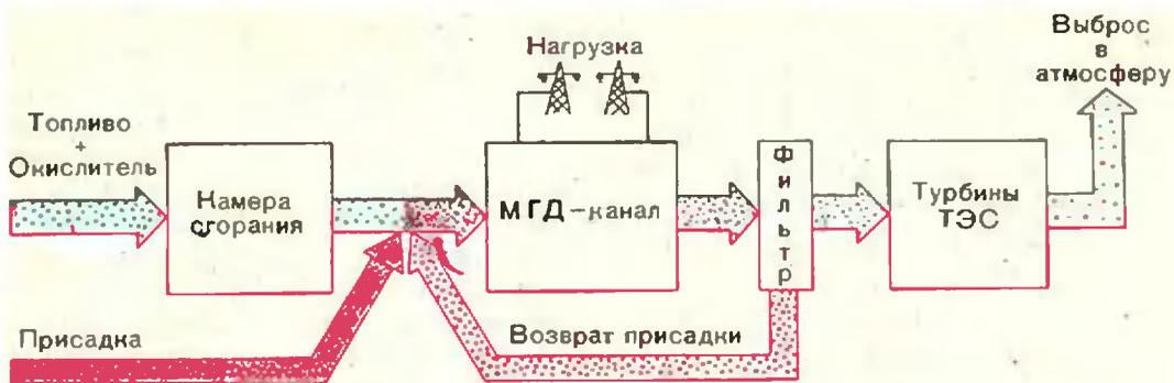
МГД-генератор с открытым циклом.
