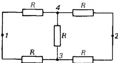
Электроплитка включается в сеть точками 1 и 2, при этом за некоторое время удается довести до кипения  $m_1 = 500$  г воды. Сколько воды можно довести до кипения за то же время, если электроплитку включить в сеть точками 1 и 3? Начальная температура воды в обоих случаях одна и та же. Тепловыми потерями пренебречь.
