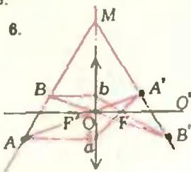
Лучи, идущие без преломления из точки  $A$  в точку  $A'$  и из точки  $B$  в точку  $B'$ , проходят через оптический центр линзы. Следовательно, точка  $O$  — оптический центр линзы (см. рис. 6).
