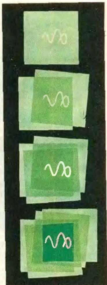
Рис. 1. Изменение видимого цвета нити накаливания от зеленого до красного при наблюдении через разное число кусочков зеленого стекла.
