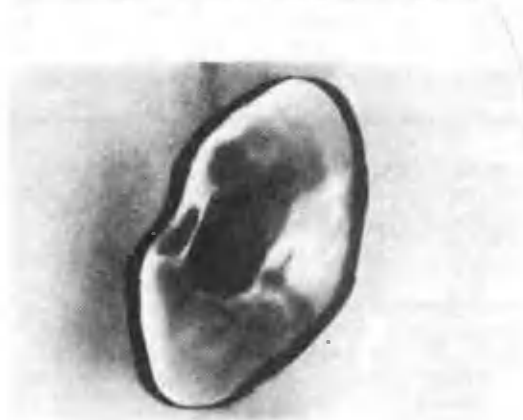
Рис. 1. Одна из фаз колебаний капли (момент наибольшего растяжения). Темное пятно в центре — образующийся внутри капли пузырьк водяного пара.
