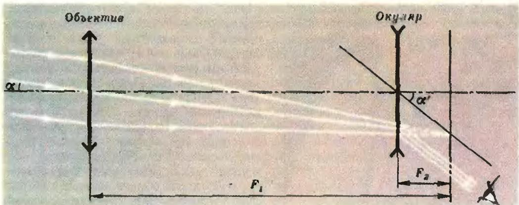
Рис. 1. Ход лучей в зрительной трубе Галилея.
