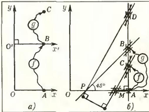
Рис. 3. а) Блок сложения; б) Блок умножения.
