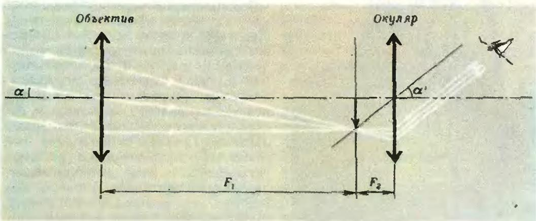
Рис. 2. Ход лучей в зрительной трубе Кеплера.
