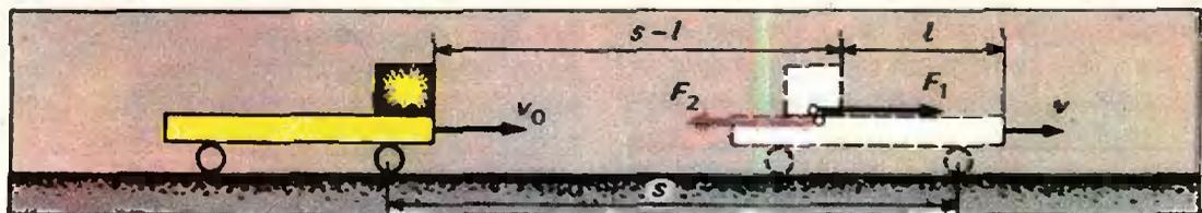
Рис. 10. Отрицательная работа на пути  $s$  больше положительной работы на пути  $s-l$ .
