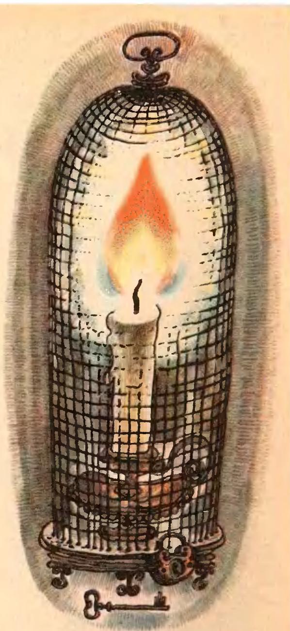
же если шахта полна легковоспламеняющимися газами, горящая лампа Дэви не вызовет взрыва — пламя не «выходит» за пределы лампы благодаря металлической сетке.
