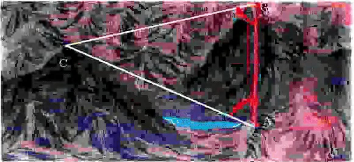
Рис. 3. Метод триангуляции. Зная длину  $AB$  и углы  $\alpha$  и  $\beta$ , можно определить расстояние до объекта  $C$ .
