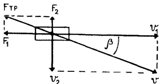
ти ( $v = v_1 + v_2$ ). Разложим силу трения на две составляющие по направлениям скоростей  $v_1$  и  $v_2$ :
