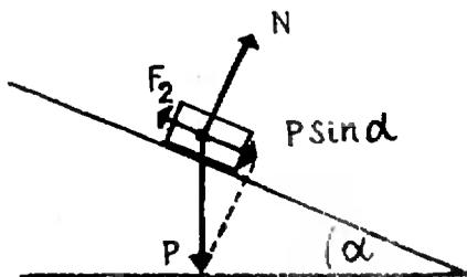
Любопытный вывод можно теперь сделать для коробка, движущегося по наклонной плоскости. Здесь  $F_2 = P \sin \alpha$ , а  $N = P \cos \alpha$  ( $P$  — вес коробка,  $\alpha$  — угол наклона плоскости к горизонту). Поэтому
