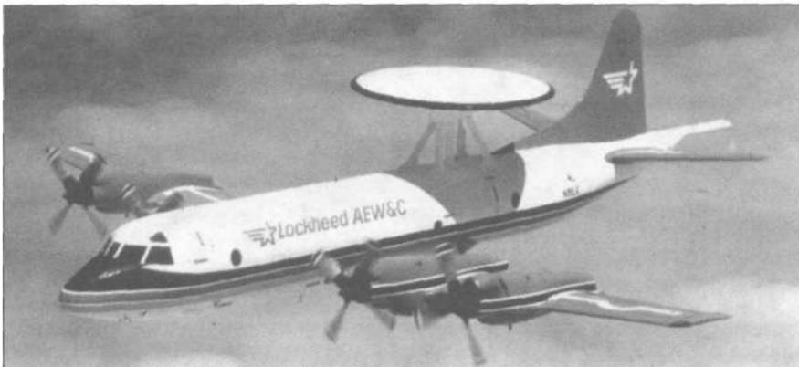
Прототип самолета ДРЛОиУ на базе Р-3.
