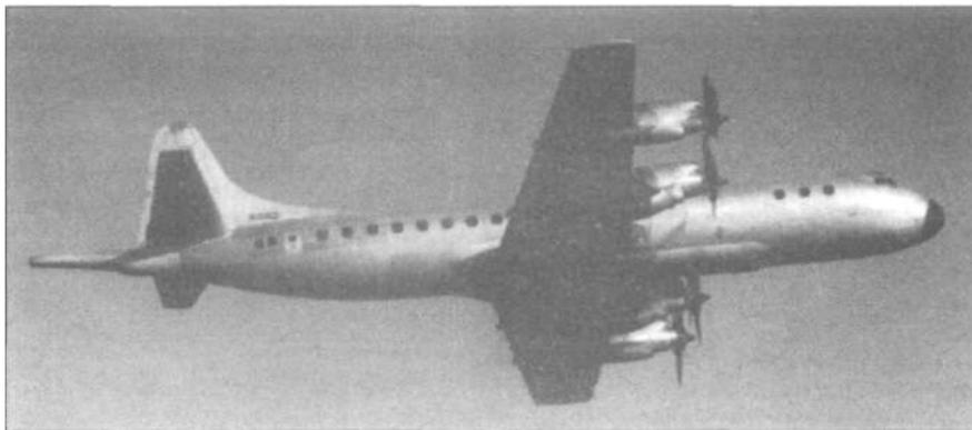
"Юнивак". Р-3С стал первым в мире самолетом ПЛО с централизованным компьютером обработки информации от поисковой и навигационной систем. Кроме того, ЭВМ выдавала команды на сброс РГБ и применение оружия. Использование ЭВМ и нового акустического процессора AQA-7 позволило резко увеличить эффективность работы гидроакустического комплекса - теперь одновременно обрабатывалась информация от 31 буя, в то время как AQA-5 позволяла "прослушивать" не более 16 РГБ.
