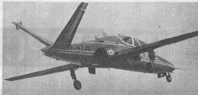
Французский учебно-тренировочный самолет «Фуга-90» с V-образным оперением.
