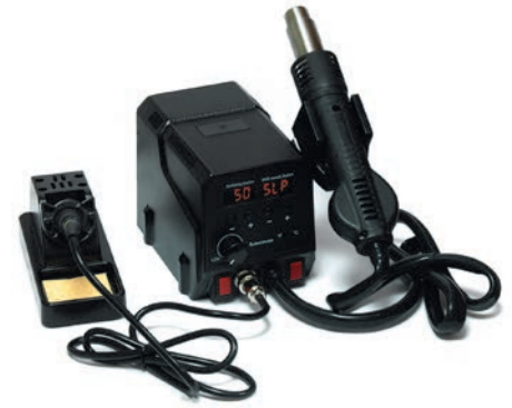
Рис. 11. Ремонтная система с термовоздушным каналом и каналом для монтажа АКТАКОМ ASE-3106
