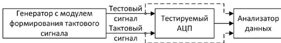
Рис. 3. Схема измерений отношения «сигнал/шум» после оцифровки и фактического динамического диапазона АЦП без фильтрации с одним генератором, включающим модуль формирования тактового сигнала
