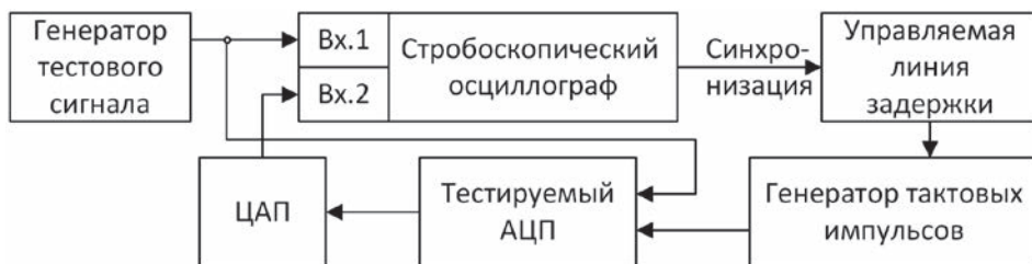
Рис. 6. Схема измерений апертурного времени с использованием образцового ЦАП
