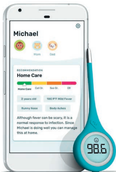
Рис. 14. Умный термометр Kinsa, работающий совместно с приложением для ПК или смартфона
