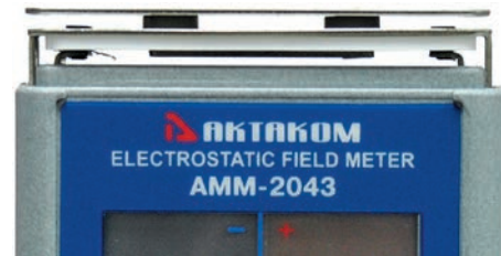
Рис. 4. Пластина для измерения ионного баланса — в зависимости от режима устанавливается в верхней или нижней части прибора
