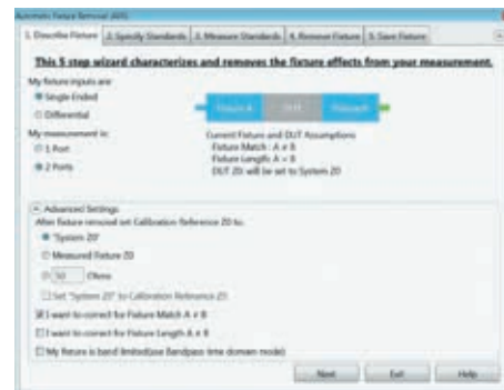
Рис. 6. Мастер настройки функции автоматического исключения влияния тестовой оснастки на результаты измерений
