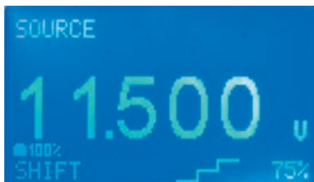
Рис. 5. Дисплей прибора в режиме сканирования отображает символ типа сканирования и мгновенное значение уровня сигнала
