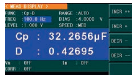
Рис. 2. Экран прибора АММ-3038 в режиме измерения емкости при параллельной схеме замещения C_p и добротности D
