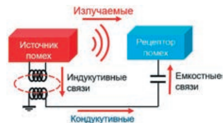
Рис. 3. Четыре механизма воздействия ЭМП на РЗА — по полю, через индуктивную и емкостную связь, а также в виде кондуктивной помехи
