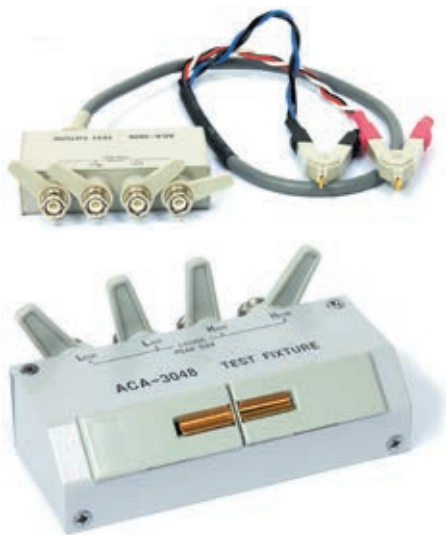
Рис. 7. Оснастка анализаторов компонентов АММ-3038/3048/3058/3068/3088. Вверху — 4-проводные щупы Кельвина для измерений установленных компонентов и крупногабаритных элементов, внизу — 4-проводный зажим для тестирования выводных компонентов
