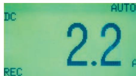
Рис. 18. Дисплей ACSM-2159 в режиме регистрации данных по расписанию
