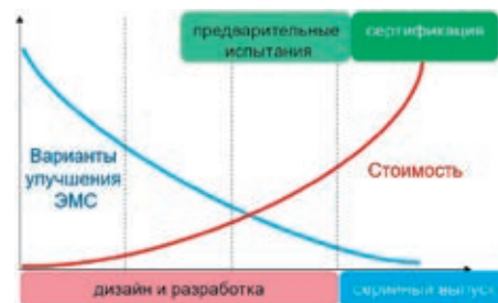
Рис. 2. Внедрение схемы проверок в контрольных точках проекта перед сертификацией может значительно повысить вероятность выполнения плана разработки РЭА в срок и в рамках бюджета
