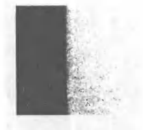
Рис. 13.2. Освещенность в плоскости наблюдения вблизи границы области геометрической тени (некогерентное освещение)
