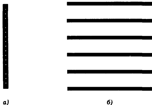
Рис. 17.9. Спектр сетки, отфильтрованный вертикальной щелью (а) и соответствующее изображение (б)
