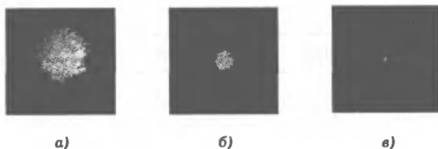
Рис. 22.3. Самофокусировка света в толуоле [4]
