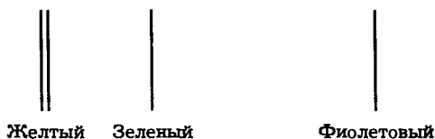
Рис. 16.11. Спектр излучения ртутной лампы, полученный с помощью отражательной дифракционной решетки
