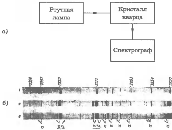
Рис. 8.11. Наблюдение комбинационного рассеяния света в кварце [12; 13]. Схема эксперимента (а). Спектр излучения ртутной лампы (спектр сравнения) и спектры света, рассеянного в кварце (б): 1 — спектр сравнения, 2 и 3 — спектры рассеянного света, снятые при 20 °С и 210 °С (экспозиция 105 ч). \alpha — красные сателлиты, \beta — фиолетовые сателлиты
