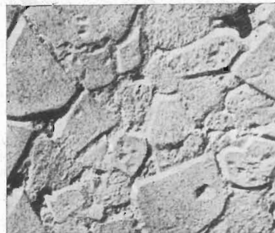
Электронно-микроскопическая фотография шлифа металлокерамического твердого сплава WC + 6\% Co (по исследованиям Чапоровой и Васильевой). \times 8000
